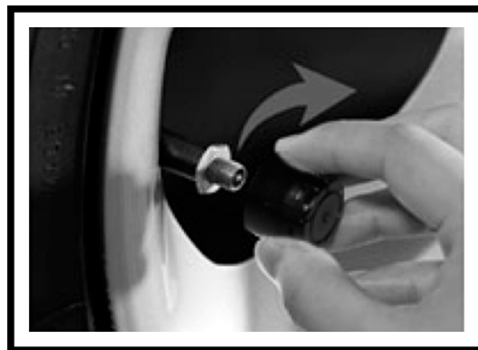
4. Vissez le capteur sur la valve
