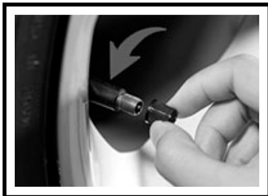
1. Entfernen Sie die Staubschutzkappe des Reifenventils
