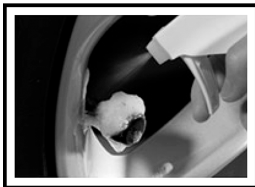
5. Controleer de dichtheid met wat sop.
