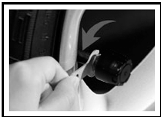
4. Draai (contra)de moer met behulp van het meegeleverde steeksleuteltje vast tegen de sensor.
