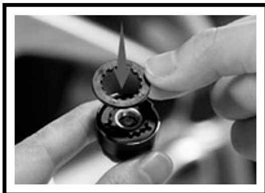
3. Setzen Sie den Profil-Ring ein
