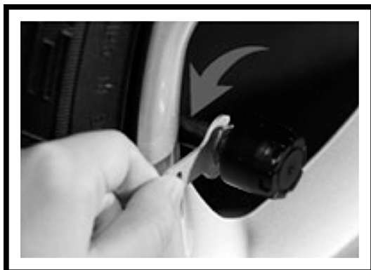
4. Kontern Sie den Sensor mit der Mutter mit Hilfe des mitgelieferten Schlüssels
