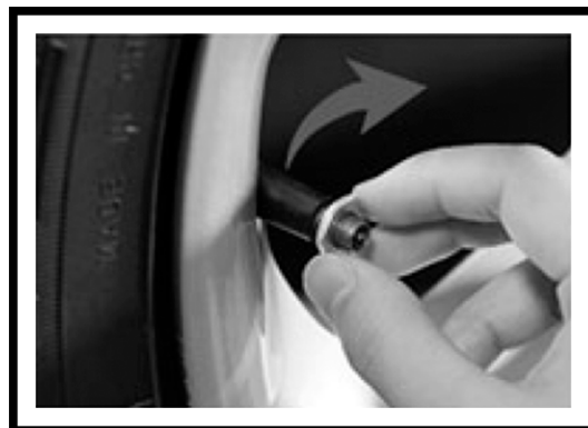
2. Vissez l'écrou 6 pans sur la valve
