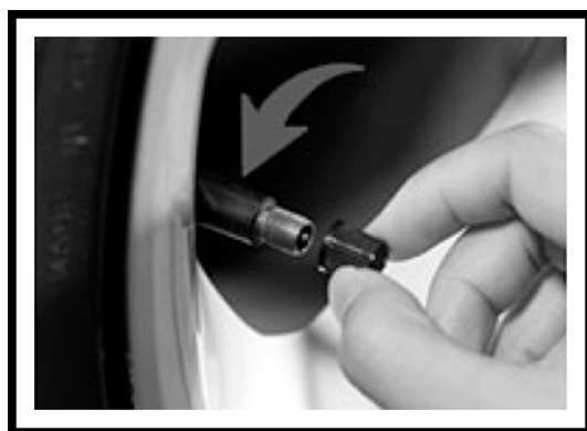
1. Rimuovere il cappuccio parapolvere della valvola dello pneumatico
