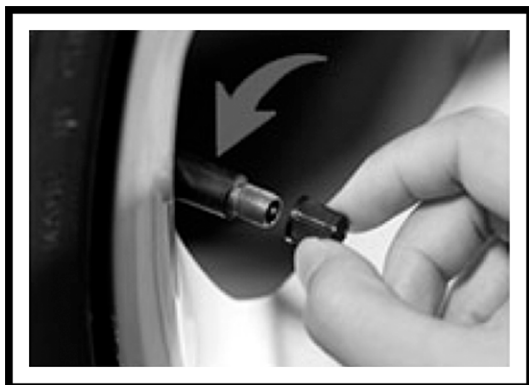
1. Retirez le bouchon de valve
