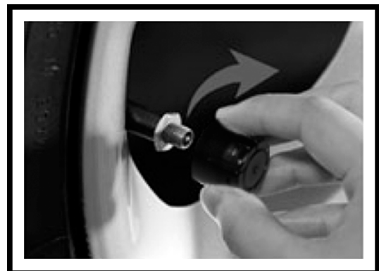
4. Schrauben Sie den jeweiligen Sensor auf das Ventil
