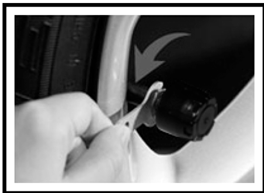
5. Contrez le capteur avec l'écrou à l'aide de la clef à molette
