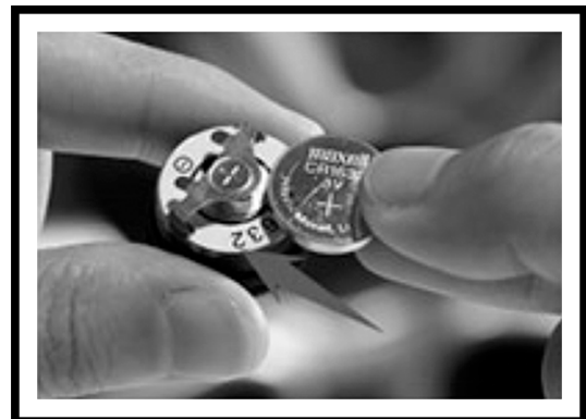
6. Tauschen Sie die CR1632 Knopfzelle (+ Seite zeigt nach oben)
