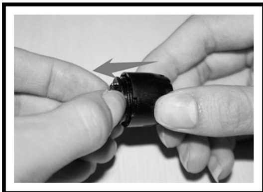
5. Ziehen Sie das Sensorgehäuse ab (mit Hilfe der Fingernägel)
