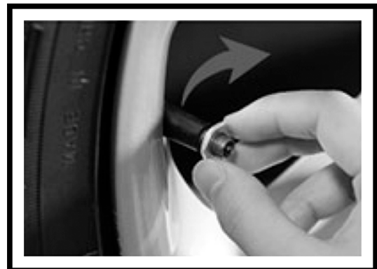
2. Schrauben Sie die mitgelieferte 6-Kant Mutter auf das Ventil
