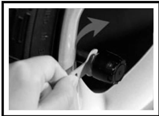
1. Met behulp van het meegeleverde steeksleuteltje de 6 kantige (contra)moer losdraaien.
