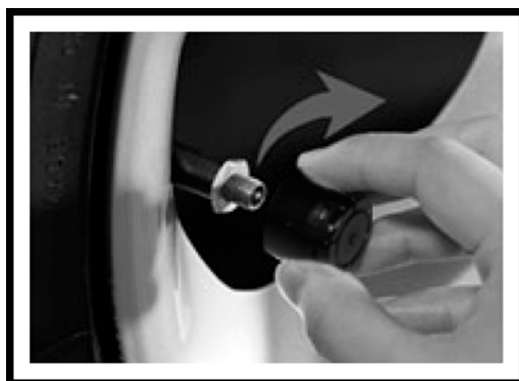
4. Schroef de betreffende sensor op het draadeinde van het ventiel.
