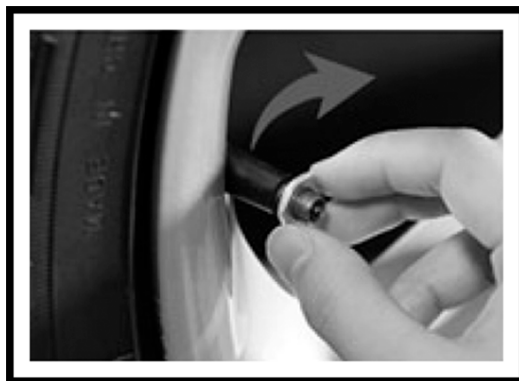
2. Schroef de meegeleverde 6 kantige moer op het draadeinde van het ventiel.
