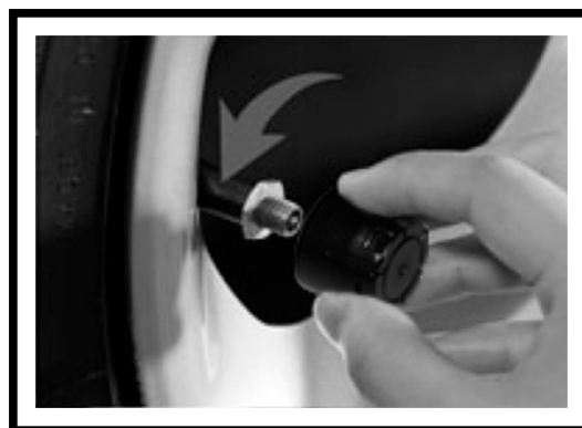
2. Dévissez le capteur de la valve
