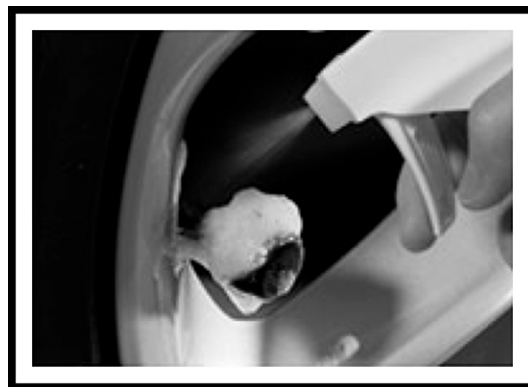
6. Vérifiez l'étanchéité (par exemple avec de l'eau savonneuse)
