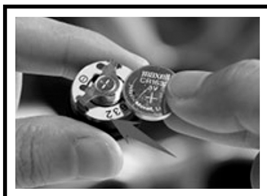
6. Cambiare la pila CR1632 (segno + verso l'alto)
