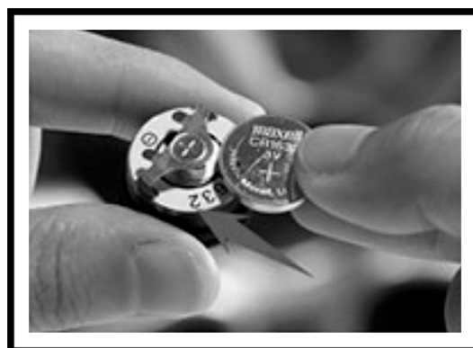
6. Remplacer la pile bouton CR1632 (+ le plus vers le haut)
