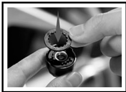
3. Inserire l'anello profilato
