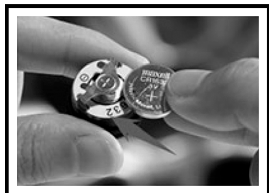
6. Verwissel de CR1632 knoopcel. (+ kant naar boven)
