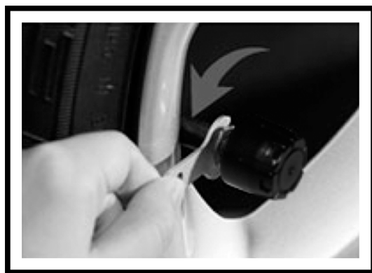
4. Fissare il sensore al dado con la chiave in dotazione
