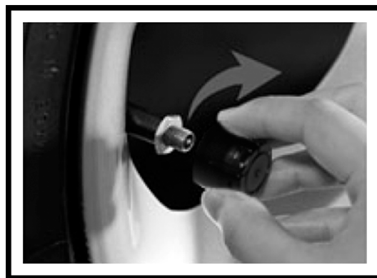
4. Avvitare il relativo sensore sulla valvola
