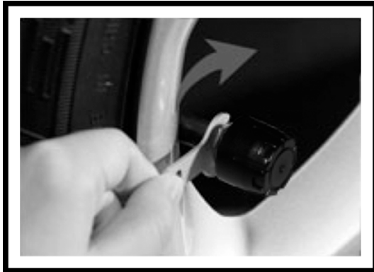
1. Lockern Sie die 6-Kant Mutter mit dem mitgelieferten Maulschlüssel
