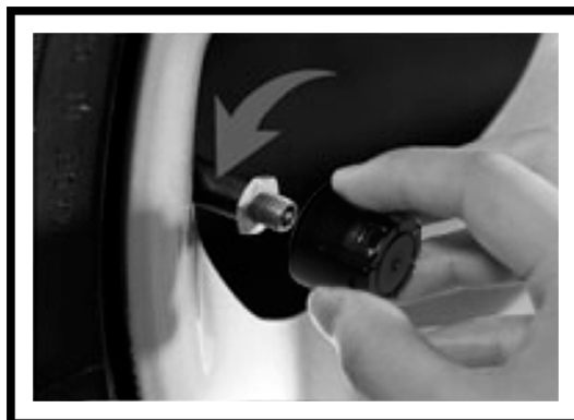
2. Rimuovere il sensore della valvola
