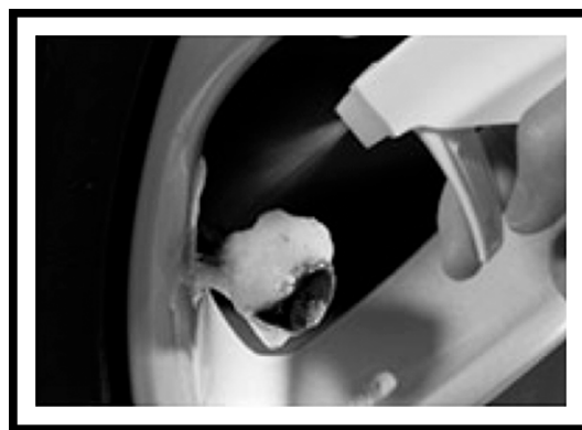
6. Controllare la tenuta (p.es. con acqua saponata)
