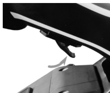
Bild 19: Lösen der Verriegelung
