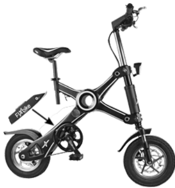
Bild 5: Einsetzen des Akkus
