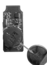
Figure 27 : Retirer le support de batterie
