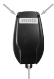
Figure 25 : Retirer les vis de boîtier
