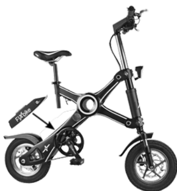
Figure 5 : Insertion de la batterie
