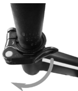
Figure 15 : Fermeture rapide fermée
