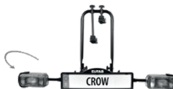
2. Apertura del fanale posteriore di sinistra
