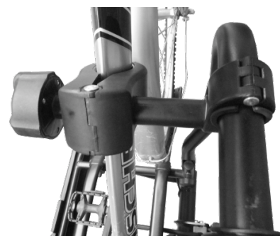
Bild 8: Befestigung des Fahrrads mit dem kurzen Rahmenhalter
